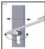
Si l'ouvrant n'est pas suffisamment étanche ou un peu cintré, tourner l'axe excentrique des rouleaux de la crémonne avec une clé BTR de 4 mm
